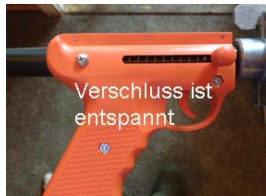
7. Um die verbrauchte Kartusche zu entfernen, drücken Sie mit dem Daumen auf die obere Verriegelung. Der Launcherkopf kippt dann nach unten über die Welle ab und Sie kommen so leicht an die vom Auszieher schon leicht herausgezogene leere Kartusche heran. Der Auszieher wirft die Kartusche nicht aus, die Hülse wird aber weit genug herausgezogen, um sie leicht zu entfernen.
