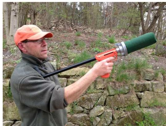
6. Ziehen Sie den Spannriegel für den Schlagbolzen zurück bis er in die verriegelte Position einrastet. Der Launcher ist gespannt, somit scharf. In dieser Stellung den Launcher niemals in Richtung Menschen, Tiere oder Gegenstände richten
